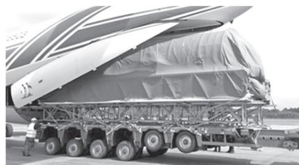
Компания обратилась за предварительной консультацией по перевозке третьей ступени ракеты-носителя в начале 2017 года. Инженерами центра грузового планирования АК «Волга-Днепр» были разработаны рекомендации по подготовке и проектированию транспортно-грузового оборудования, пошаговая технология погрузки аэрокосмического оборудования для перевозки на борту грузового самолета Ил-76ТД-90ВД.
